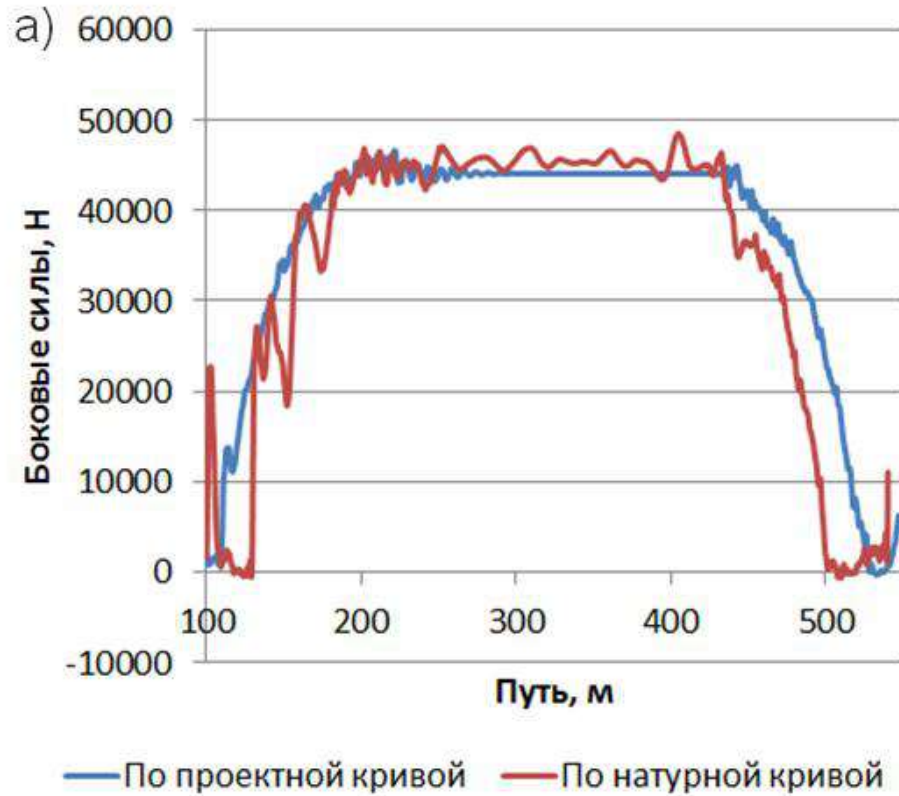
Рисунок 3.4 – Результаты расчета боковых сил: а) со скоростью движения 60 км/ч; б) со скоростью движения 80 км/ч.
