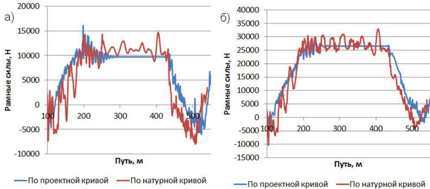
Рисунок 3.3 – Результаты расчета рамных сил: а) со скоростью движения 60 км/ч; б) со скоростью движения 80 км/ч.
