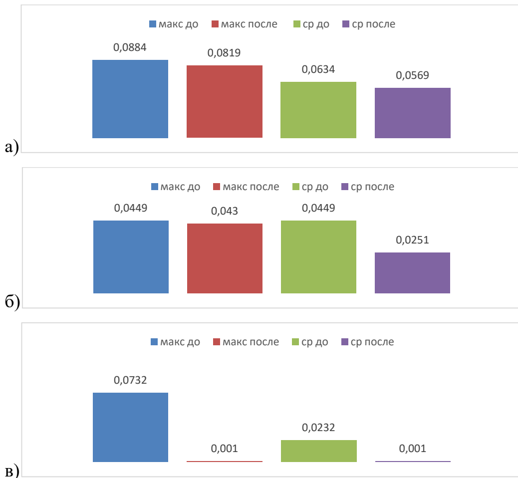
Рисунок 4.6 – Изменение величины интенсивности бокового износа (мм/млн. т) в кривых Южно-Уральской ж.д. до и после ремонта в диапазонах радиуса: а) 450-650 м б) 650-1000 м в) более 1000 м
